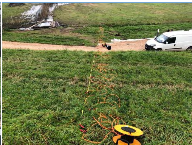
Foto 4 – Acquisizione dati ERT-T3
