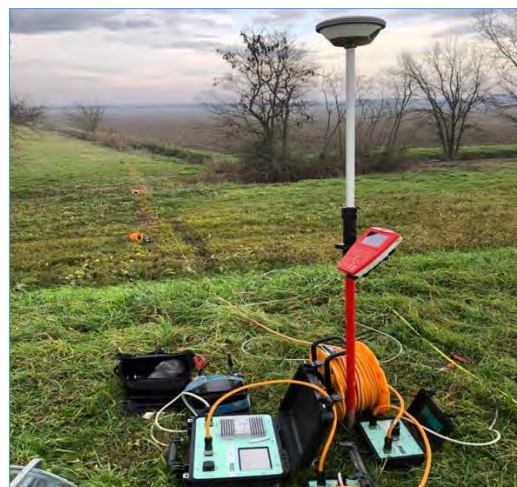
Foto 6 – Acquisizione dati ERT-T4 (Pasi Polares)
