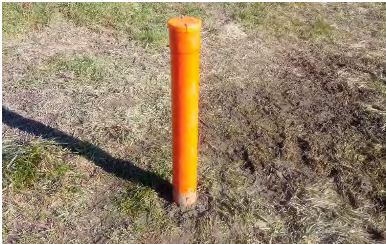
A.I.Po - Cavanella Po - Sondaggio SC - Pozzetto di protezione piezometro
