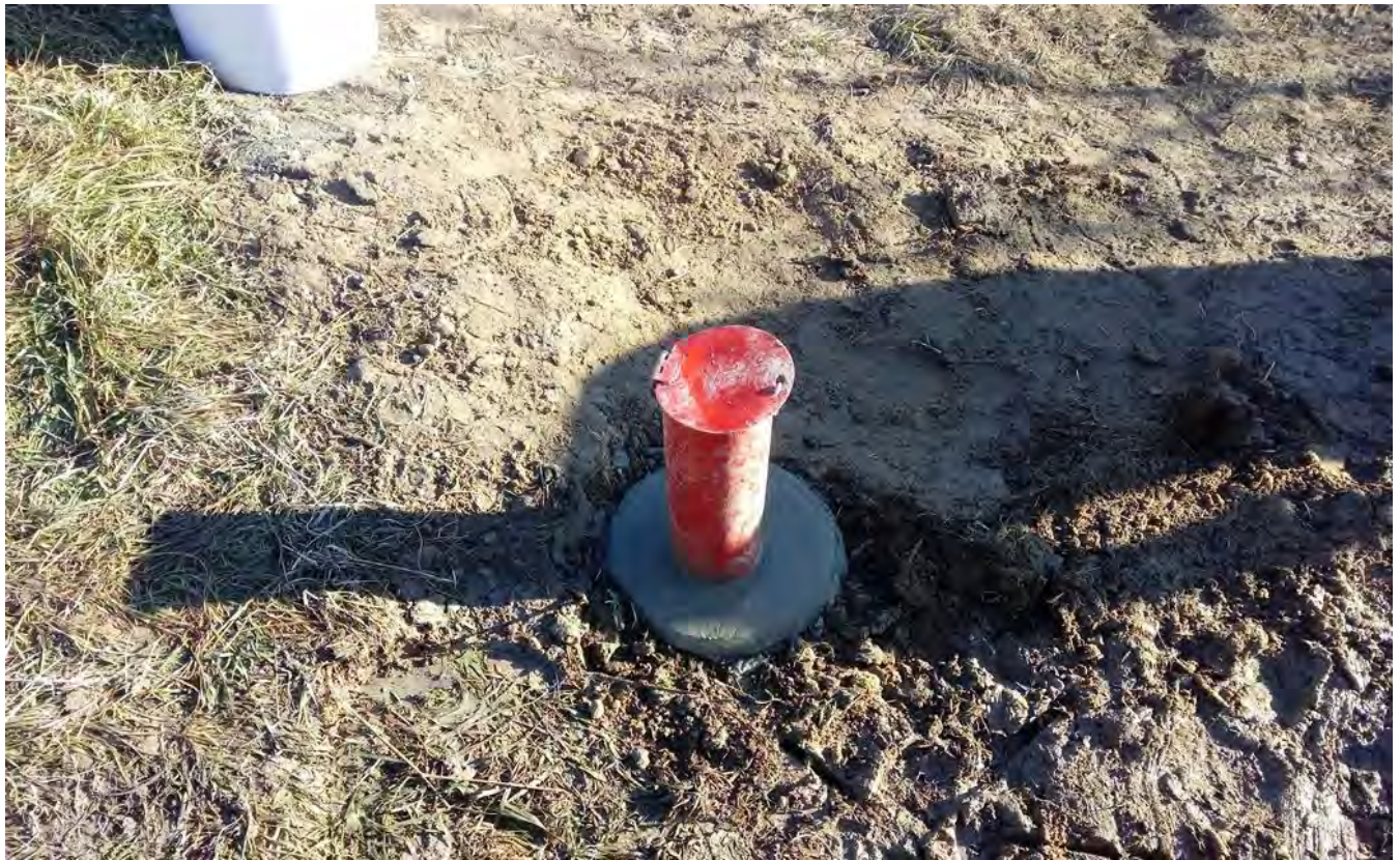
A.I.Po - Cavanella Po - Sondaggio SA - Pozzetto di protezione piezometro
