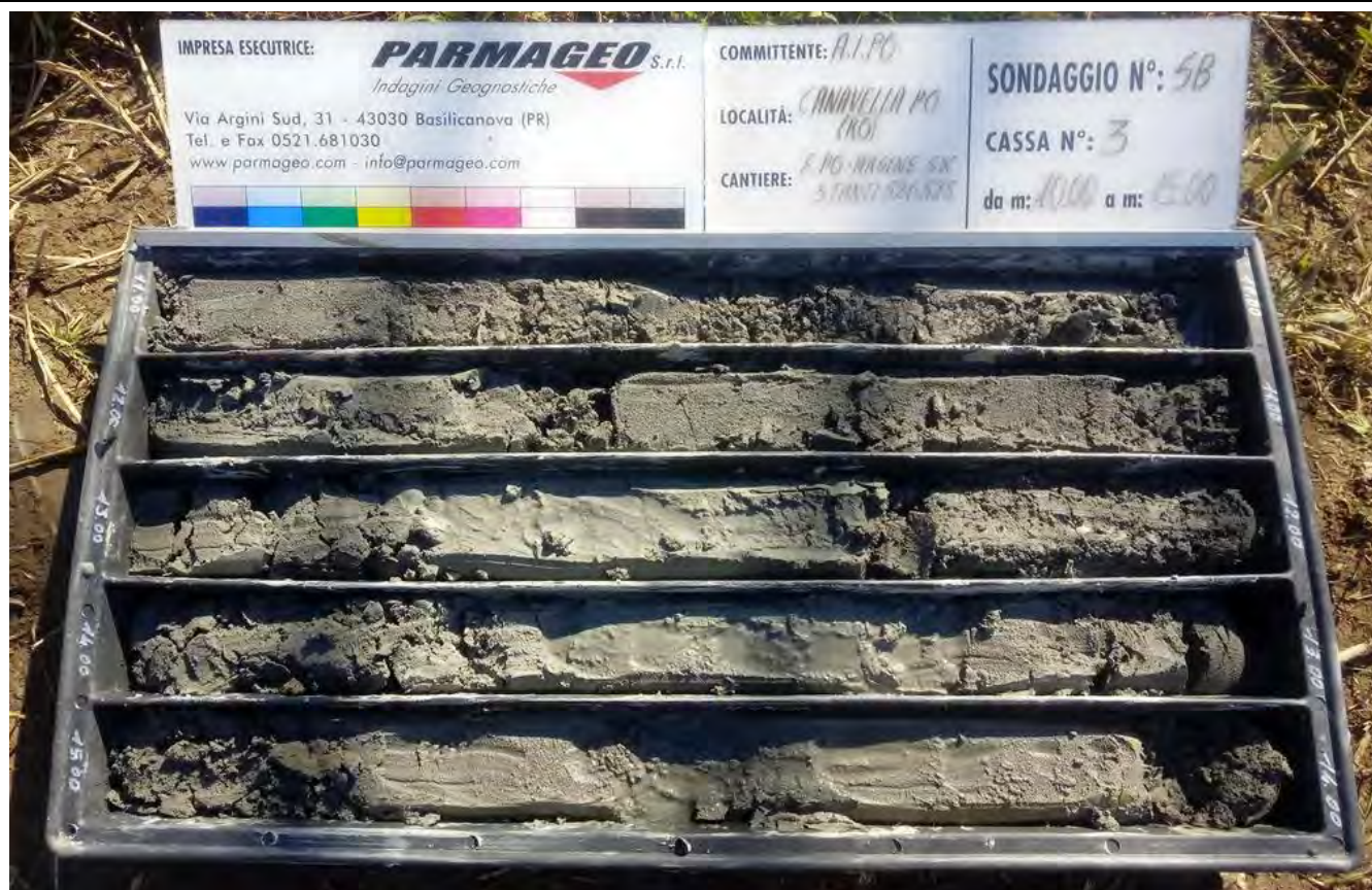
A.I.Po - Cavanella Po - Sondaggio SB - Cassa 3 (10.0 ÷ 15.0 m)
