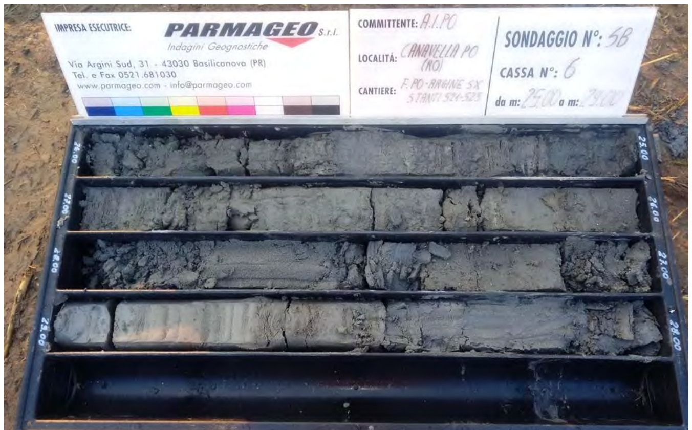
A.I.Po - Cavanella Po - Sondaggio SB - Cassa 6 (25.0 ÷ 29.0 m)
