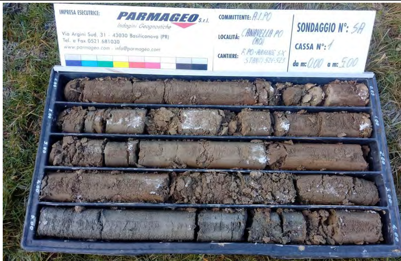
A.I.Po - Cavanella Po - Sondaggio SA - Cassa 1 (0.0 ÷ 5.0 m)
