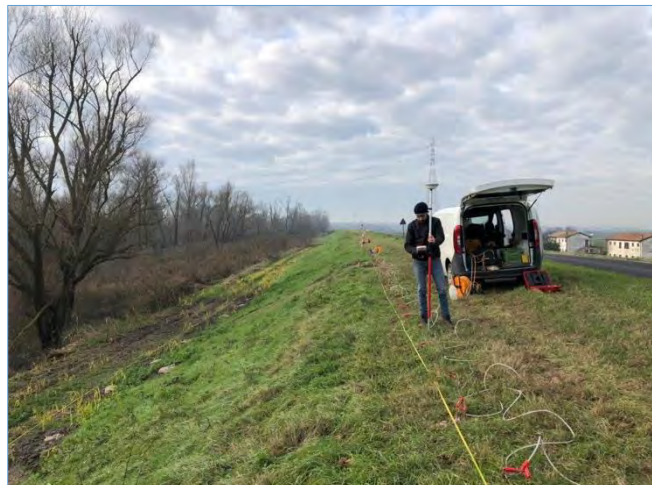
Foto 1 – Acquisizione dati ERT-L1 e rilievo GPS
