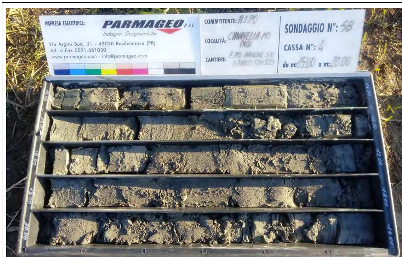
A.I.Po - Cavanella Po - Sondaggio SB - Cassa 4 (15.0 ÷ 20.0 m)
